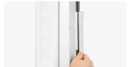
10.) Sollte eine Mitteldichtung\* vorhanden sein, ist diese direkt gegenüber des FensterLüfto® auf Lüfterlänge zusätzlich zu entfernen. Werden zwei Lüfter montiert, ist die Mitteldichtung gegenüber beider Lüfter auf Lüfterlänge zu entfernen.
